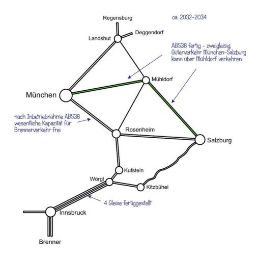
mit Inbetriebnahme des Brennerbasistunnels insgesamt 4 Gleise. Beginn Brennerverkehr (Verkehrszunahme)
